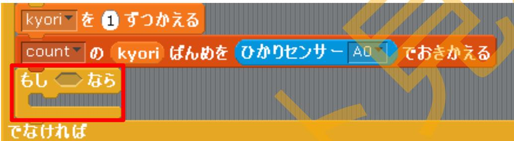
「へんすう」にある「kyori」と「(>0)」をもってきて、<sup>した</sup>下図のように作成<sup>さくせい</sup>します。「もしkyori>2ならば~」の<sup>なか</sup>中に「kyoriを0にする」をもってきます。
