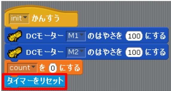
「赤外線センサーが床を感知しない時のプログラム」を実行する場合も、最初は「タイマーをリセット」をします。
