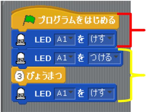
「初期処理」で最初に LED を けします。はじめは「初期処理」でみどりいろ (A1) が消灯します。すぐに、みどりいろ (A1) が 3 秒の間だけ点灯します。3 秒すぎると、みどりいろ (A1) は消灯します。
