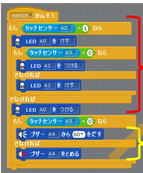
「3.スイッチがOFFの時にボタンスイッチを押すとみどりいろLED点灯」のプログラム
