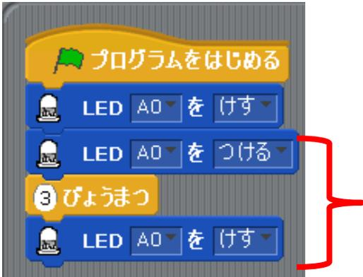
「初期処理」で最初に LED を けします。はじめは「初期処理」であかいろ (AO) が消灯します。すぐに、あかいろ (AO) が 3 秒の間だけ点灯します。3 秒すぎると、あかいろ (AO) は消灯します。
