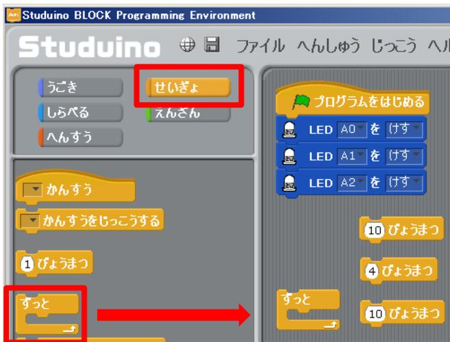
LEDの点滅の動きを常にさせるのは「せいぎよ」の中の「ずっと」を利用します。これを右に持ってきます。
