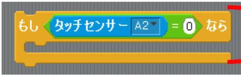
「もし～なら」の中なかに「タッチセンサーA2」と「( )=(0)」を左ひだりのように作成さくせいします。
