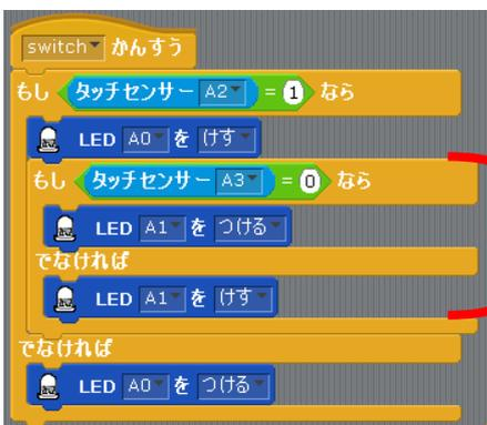
スイッチがOFF(タッチセンサーA2 = 1)の時にボタンスイッチを押すと、みどりいろLEDは点灯します。先に作成したスイッチのきりかえのプログラムの「LED(A0)をけす」の下にいます。
