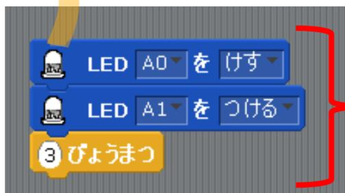
押しボタンが押された時、最初に点灯していた自動車用信号機をあおを消灯させて、きいろを3秒の間点灯させます。
