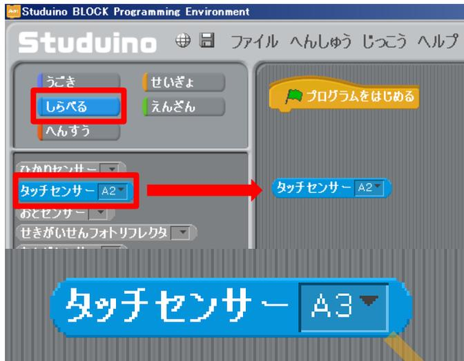
「ボタンスイッチ」は「しらべる」の中の「タッチセンサー」を利用します。これを右に持ってきます。タッチセンサーを「タッチセンサー(A3)」にします。
