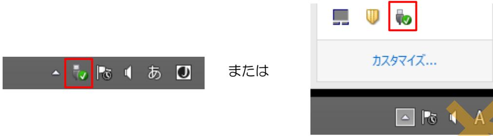
これを右クリックして、下図のようにUSBメモリが接続されていることを確認します。
