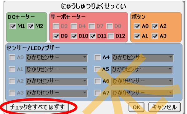
「センサー/LED/ブザー」の「AO」にチェックし、項目を「LED」にクリックしてください。
