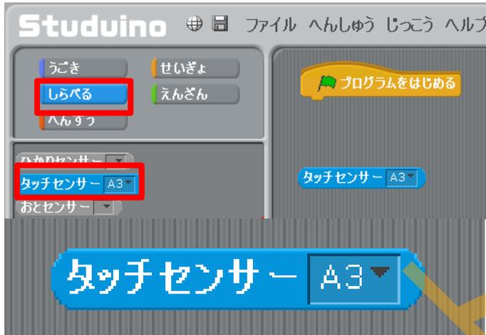
「押しボタン」は「しらべる」の中の「タッチセンサー」を利用します。これを右にも持ってきます。タッチセンサーを「タッチセンサー(A3)」にします。
