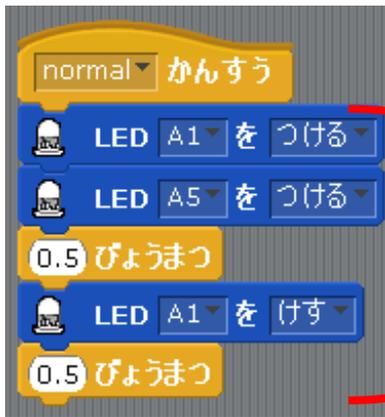
「[normal]かんすう」にきいろ(A1)を点滅させるプログラムを作成します。歩行者用信号のアカ(A5)と自動車用信号のきいろ(A1)を点灯させて、0.5秒の間隔をおいてからきいろ(A1)を消灯し、また0.5秒の間隔をおきます。
