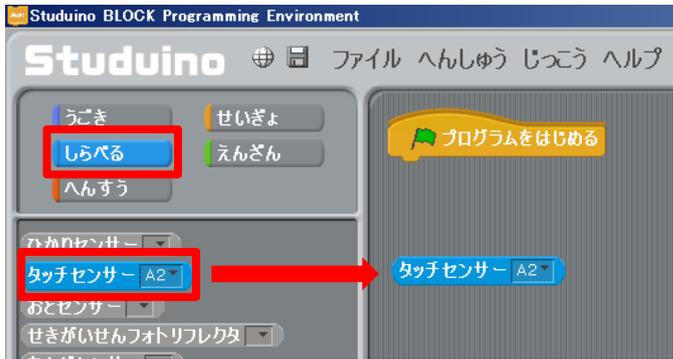
「スイッチ」は「しらべる」の中の「タッチセンサー」を利用します。これを右に持ってきます。タッチセンサーを「タッチセンサー(A2)」にします。
