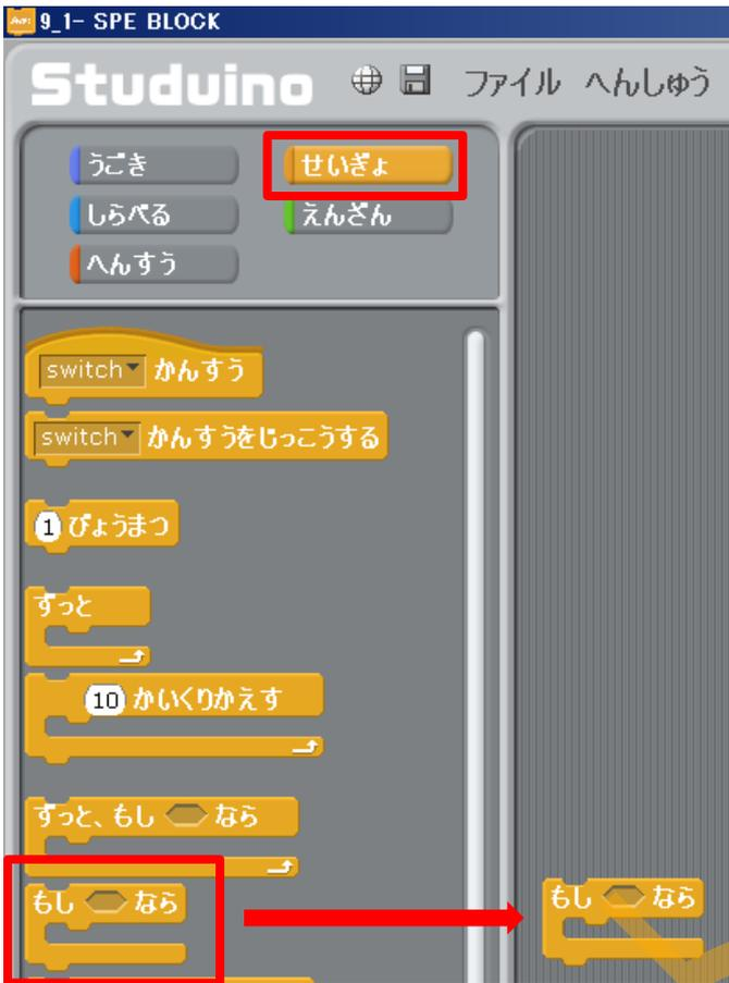
「ボタンスイッチ」を押した時に動きをさせるため、「せいぎよ」の中の「もし～なら」を利用します。
